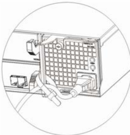
图4-30 安装电源线示意图（三）
